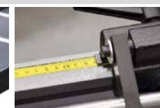
Měřicí stupnice je umístěna na masivní liště ve vyřezované drážce. Vozík dorazu je opatřen ručičkou přímo nad měřicím pásmem.
