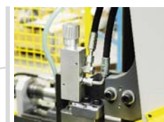
Automatická regulace přítlaku ramene do řezu
