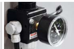
Ukazatel a regulace vstupního tlaku s filtrem
