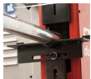
Nastavitelný kryt vstupu odjehlovací části stroje, poskytuje maximální pracovní variabilitu
