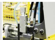
Automatická regulace přítlaku ramene do řezu
