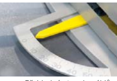
Přehledná stupnice úhlů, ergonomicky umístěna na přední straně stroje.
