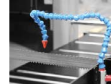
3. přívod chladicí kapaliny
