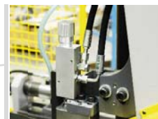
Automatická regulace přitlaku ramene do řezu
