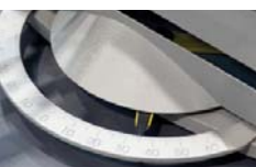
Přehledná stupnice úhlů, ergonomicky umístěna na přední straně stroje.
