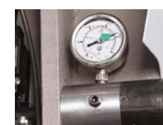
Ukazatel napnutí pásu Ukazatel napnutí pilového pásu umožňuje permanentní kontrolu napnutí pásu pily i během provozu stroje.
