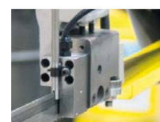
Micro-Spray-System Pro ideální řezání trubek a profilů nanáší jednotka mikroostřikování mazací film na hroty zubů a boční strany pilových pásů.
