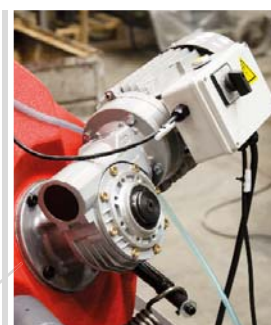
Dvourychlostní motor se šnekovou převodovkou
