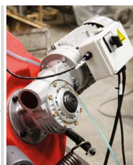
Dvourychlostní motor se šnekovou převodovkou
