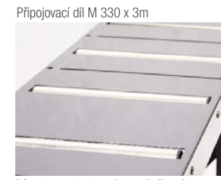
Přípojovací díl M 330 x 3m Díky konstrukci systému válečkových drah M je celý úložný prostor zakryt a je tak zajištěn bezpečnostní standard pro Váš podnik.
