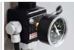
Ukazatel a regulace vstupního tlaku s filtrem
