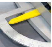
Přehledná stupnice úhlů, ergonomicky umístěna na přední straně stroje.
