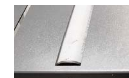
Tuhé plastové válečky zajišťují plynulý pohyb materiálu a zároveň ochranu před jeho poškozením
