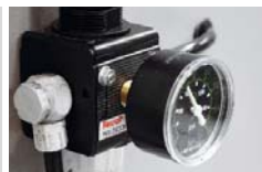
Ukazatel a regulace vstupního tlaku s filtrem
