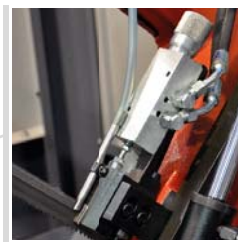
Automatická regulace tlaku do řezu
