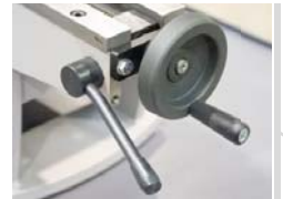
Ruční svěrák s QUICK MOVE systémem pro rychlé a pohodlné upnutí materiálu
