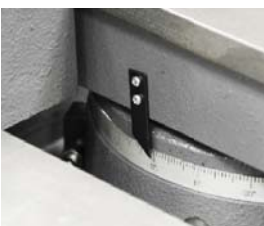
Stupnice úhlu natočení ramene
