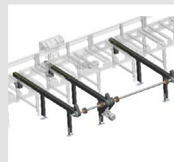
Příčné podavače s předním vyložení, pohonu jednotkou příčných podavačů a vlastní hydraulickou zvedací jednotkou
