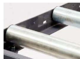
Systém T je vybaven válečky s ø70 mm a zvládne tak i nejvyšší zatížení
