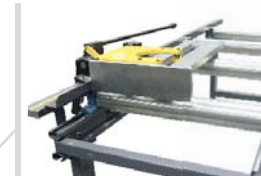
XA ruční doraz materiálu. Nastavení délky a fixace vozíku je ruční. Délka se odečítá na pásmové stupnici pomocí vestavěné lupy. Doraz lze manuálně vykloupat vzhůru pro plynulý odvod materiálu.
