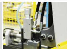
Automatická regulace přítlaču ramene do řezu
