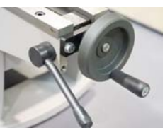
Ruční svěrák s QUICK MOVE systémem pro rychlé a pohodlné upnutí materiálu
